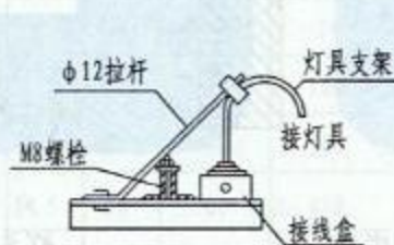
灯具在钢屋架上安装
