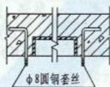
现浇楼板预留螺栓
